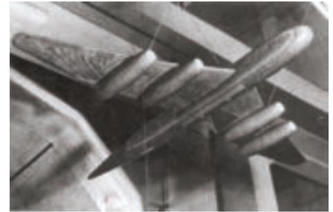
*Bahnbrechend für den Bau schneller Flugzeuge war die Entwicklung des Pfeilflügels durch Adolf Busemann. Hier ein Arado-Modell mit Pfeilflügeln in einem kleineren Windkanal.*
